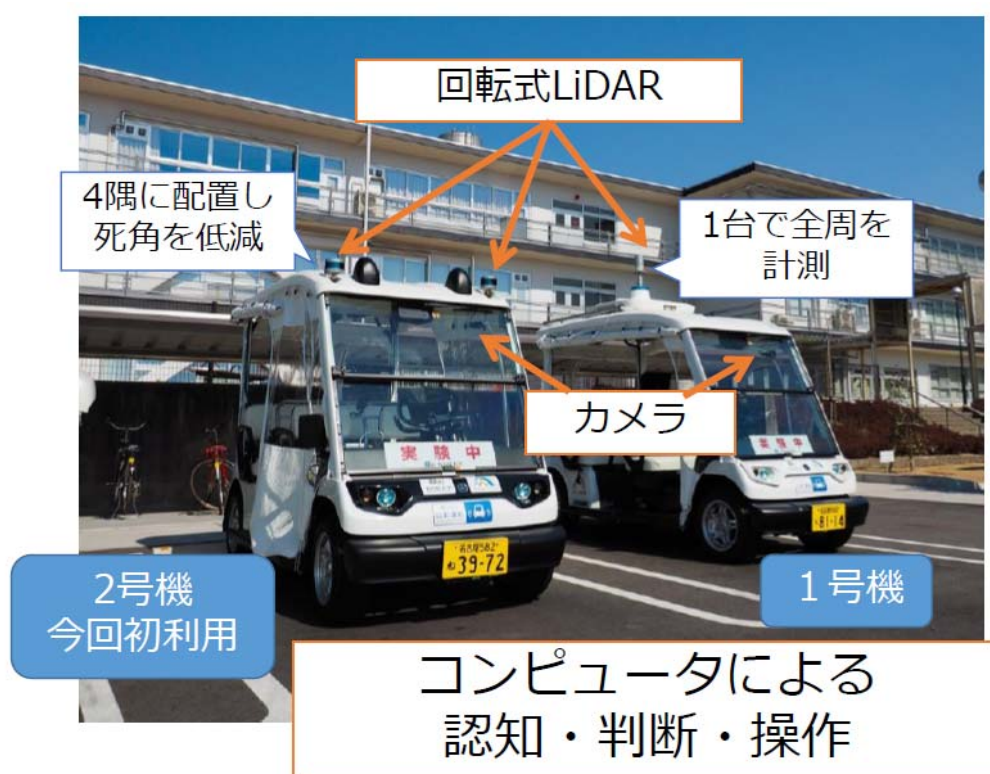
図-12 自動運転実証実験に用いた車両
